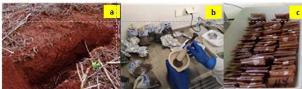
FIGURA 1A. Coleta e processamento de amostras de solo: a) trincheira para coleta; b) preparo das amostras para análise; d) amostras separadas para análises.
